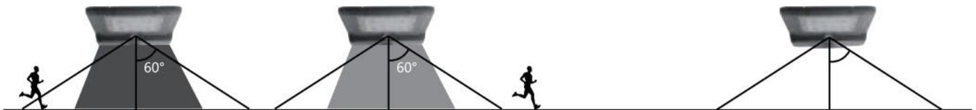
Schaltet sich automatisch mit voller Helligkeit ein wenn eine Bewegung im Bereich  $\leq 8\text{m}$  erkannt wird, nach 20 Sekunden ohne Bewegung wird die Leuchte runter gedimmt, danach schaltet sie sich nach 5 minuten aus /
